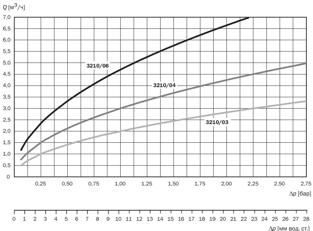
Рис. 2. Рабочие характеристики клапанов при их полном открытии
