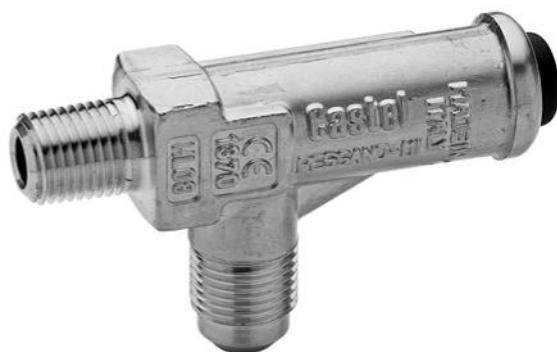
Клапаны серии 3060 — несбалансированные предохранительные клапаны прямой нагрузки. Открытие клапана производится посредством давления хладагента на его седло, если давление превышает противодействующую силу пружины, удерживающей седло.
