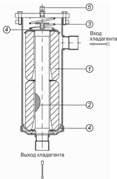
Фильтр с двумя сменными вставками в разрезе:
